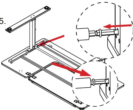
Круглую трубку (D) вставить в центр оси ножки (С) и в центр оси ножки (В). Используйте гаечный ключ (3) и винты (1) для закрепления ножки (В) на раме рабочего стола, но не затягивайте. Поместите круглую трубку в среднее положение, и переместите уплотнительное кольцо в канавку.
